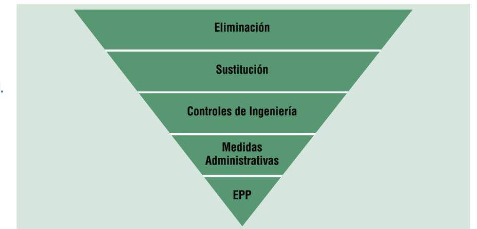
**Eliminación:** se modifica el diseño para eliminar el peligro; por ejemplo, la introducción de dispositivos de elevación mecánica para eliminar el peligro de la manipulación manual.
